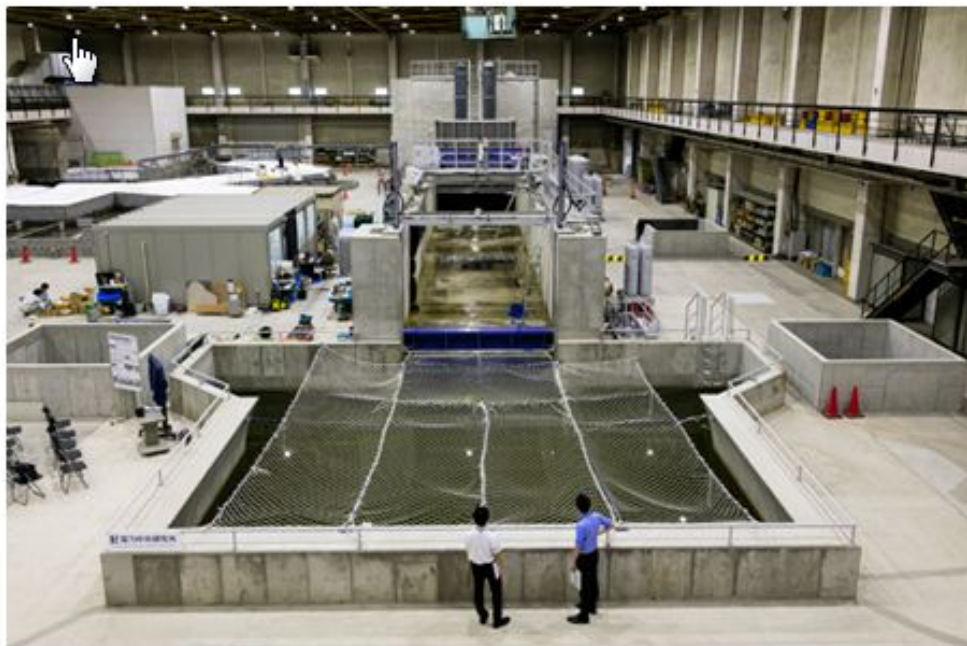
▲ 陸上氾濫津波を3分の1のスケールで再現する「津波・氾濫流水路」
