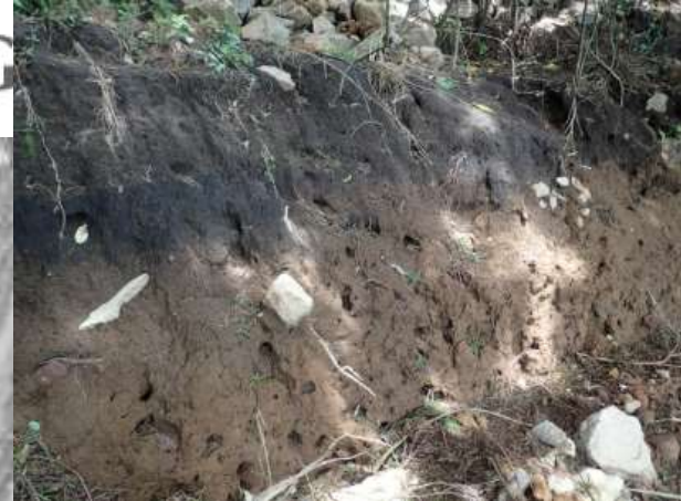
図3.1-23 小規模崩壊滑落崖のパイピング痕
