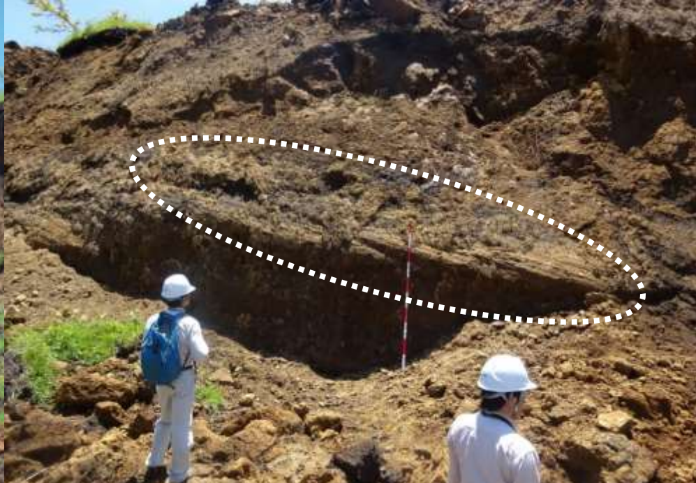
写真3.1-3 側方崖（崩壊時の土塊の擦跡が残る）
