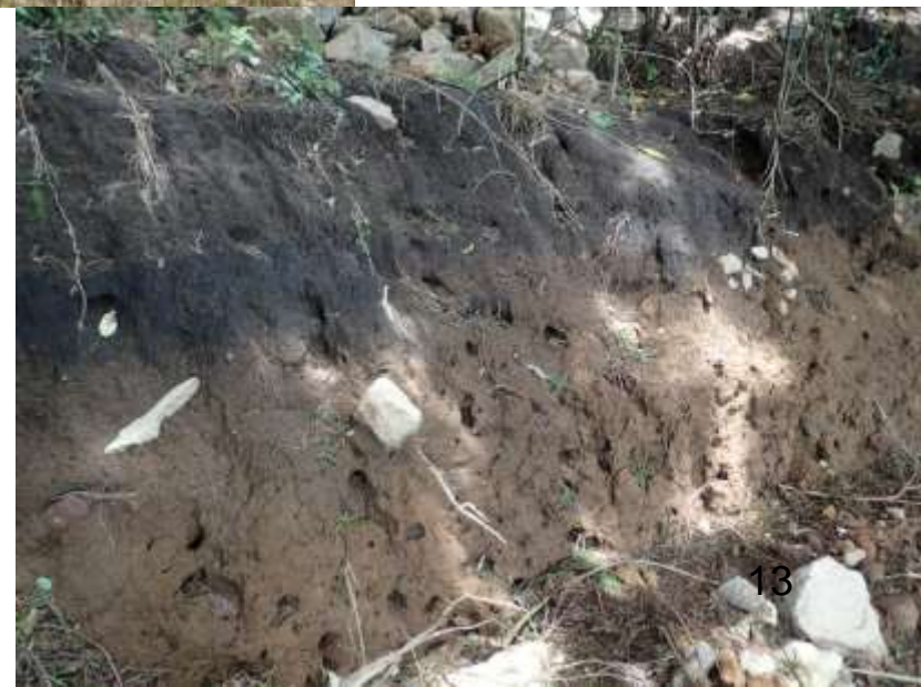
図3.1-23 小規模崩壊滑落崖の パイピング痕
