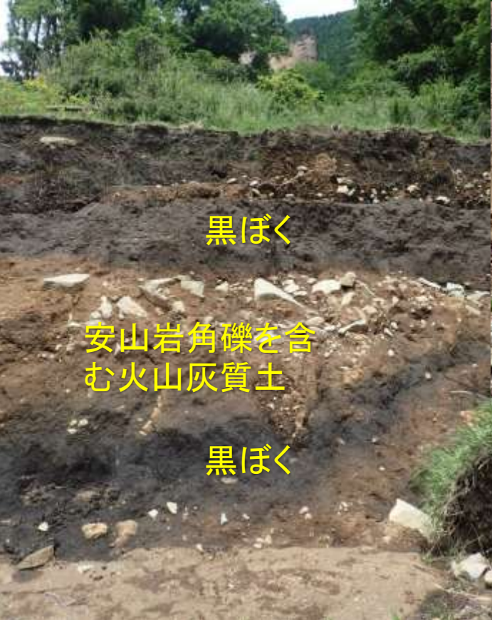
図3.1-15 小規模崩壊の頭部 滑落崖
