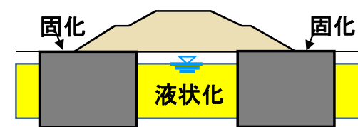
(2) 地盤の液状化に対する固化対策
