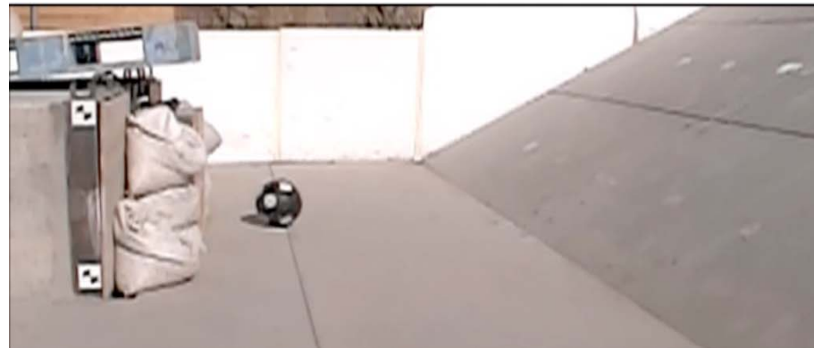
岩塊模型の斜面滑落実験
