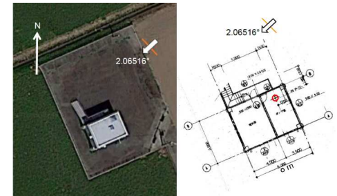
鋼製井戸ケーシングが建屋床に接続する位置(赤印)と建屋傾斜方向, 傾斜角度
