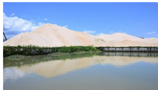
高萩工場内の砂山:ろ過砂の原料
