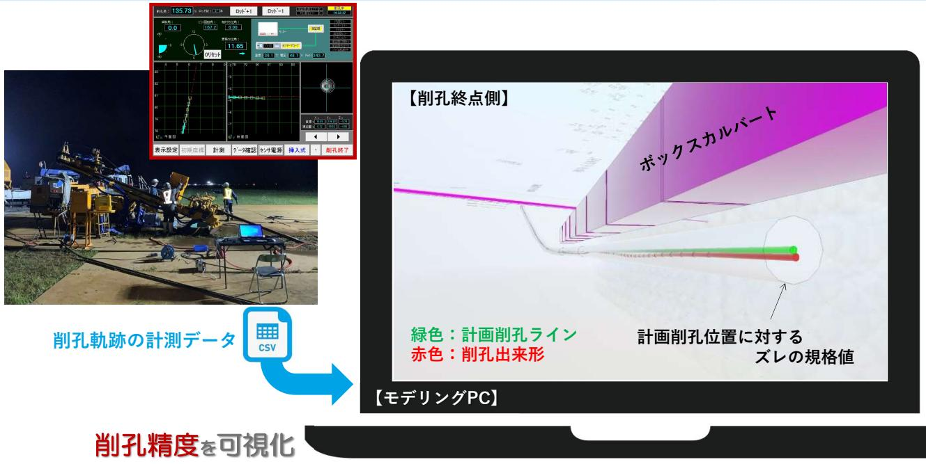
参考文献：施工実績を基にしたBIM/CIMによる削孔出来形管理方法の適用事例，土木情報学シンポジウム講演集，vol.47, pp.217-220, 2022.
