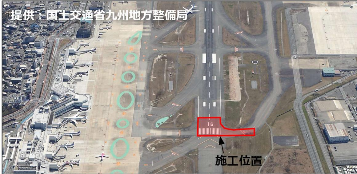
参考文献：供用中の空港滑走路に対する液状化対策施工事例 曲がり削孔式浸透固化処理工法，土木施工，Vol. 63, No. 4, pp.68-71, 2022.
