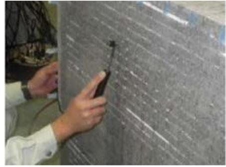
図 3.3.2.17 接触時間法の測定状況<sup>9)</sup>
