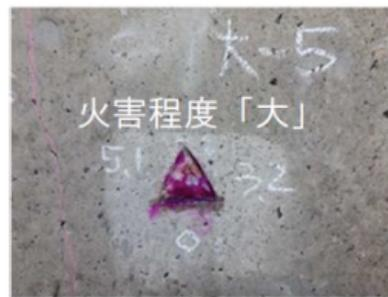
写真 4. 2. 10. 2 現位置でのフェノール法による中性化試験結果
