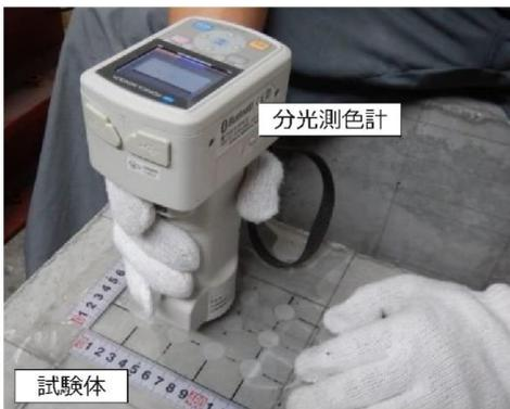
図 3.3.2.1 分光測色計による色彩測定の様相<sup>1)</sup>
