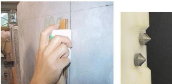
図 3.3.2.13 引っかき傷法(直読法)の試験状況と引っかき試験機<sup>4)</sup>
