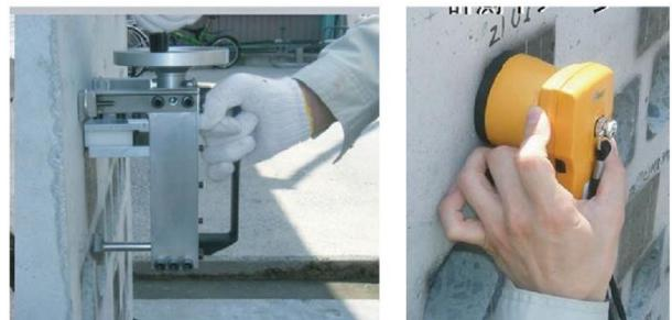
図 3.3.2.14 引っかき傷法(光学測定法)の測定状況<sup>4)</sup>
