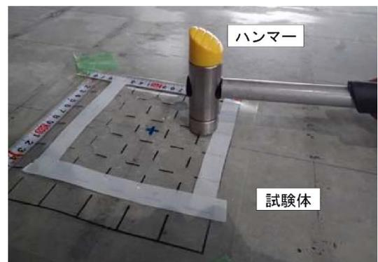
図 3.3.2.6 ハンマーによる打撃状況<sup>5)</sup>
