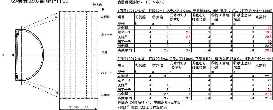
図 2.4.4 トンネルの表層目視評価結果
