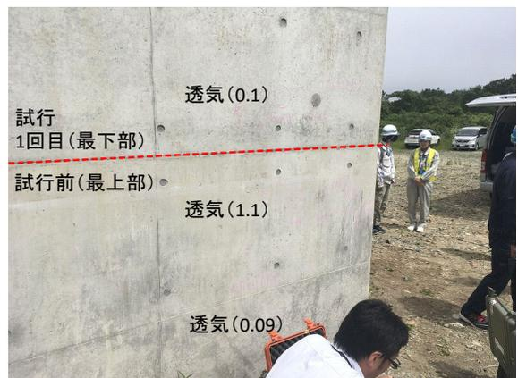
写真 2.4.10 透気係数測定結果
