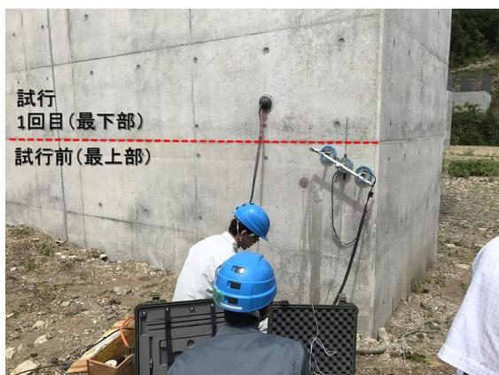
写真 2.4.9 透気係数と吸水量の測定状況
