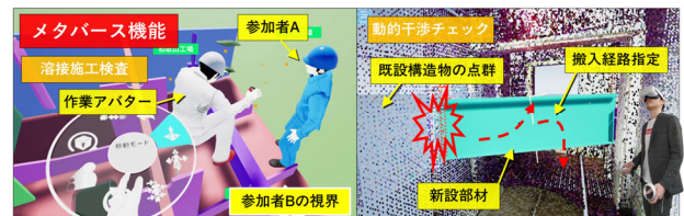
図-9 メタバース機能と動的干渉チェック機能
