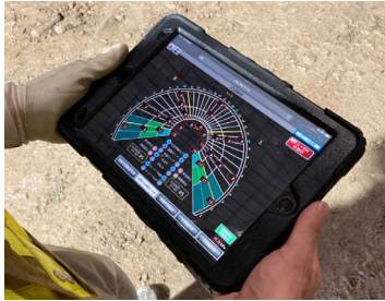
図-7 コンクリートの充填状況の確認
