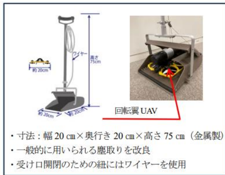
図-3 離発着装置（カタパルト）の外観
