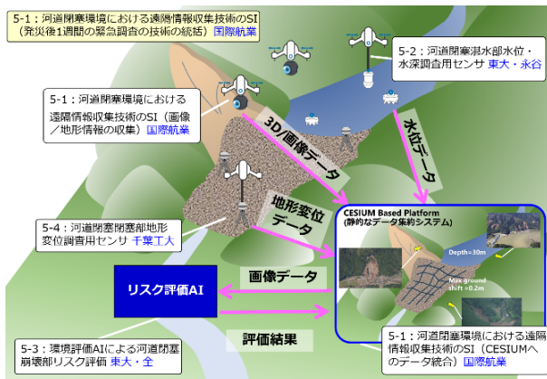
図3 河道閉塞環境における緊急調査技術の開発
