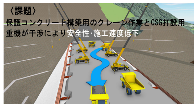
図-5 従来工法での施工状況と課題
