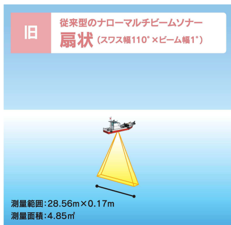
図-3 従来のマルチビームソナー測量イメージ
