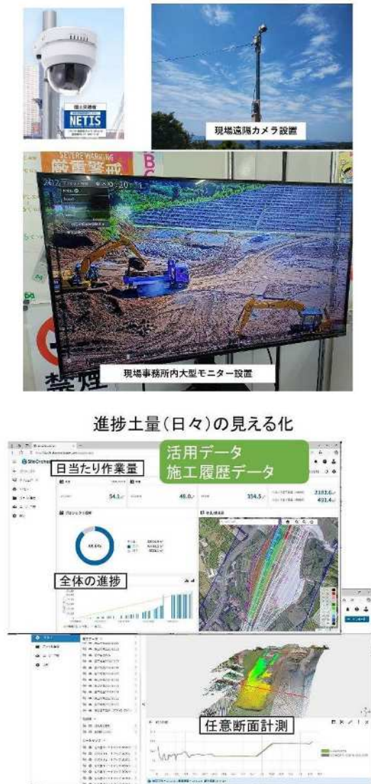
図-5 現場遠隔カメラ（NITIS登録商品）及び WEBアプリケーション（施工履歴データ管理）
