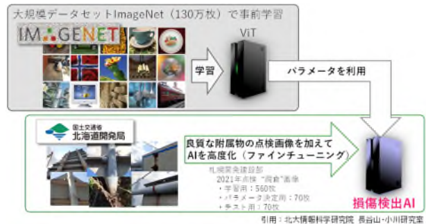
図-3 道路附属物損傷検出AI
