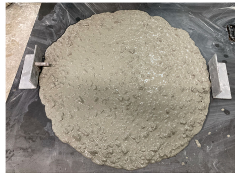
図-4 低炭素型自己充填コンクリートの性状
