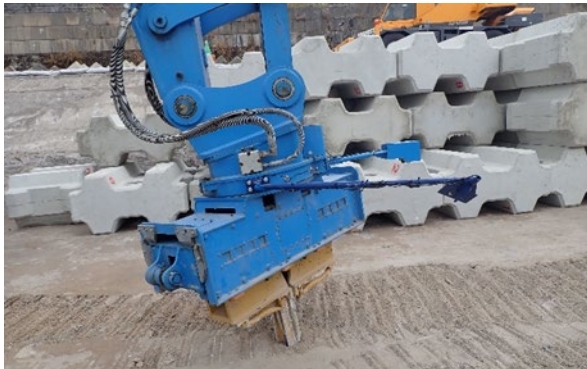
図-2 把持装置（センターホール挿入型）
