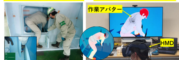
図-8 メタバース橋梁施工シミュレーションシステム
