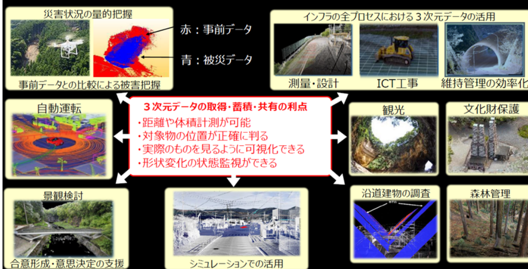
図 4-6 3次元点群データの利活用 59
