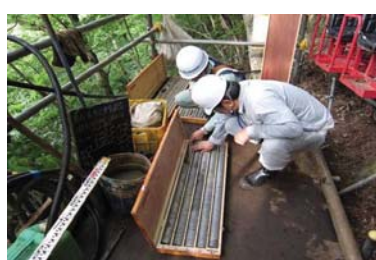
▲ボーリングの確認
