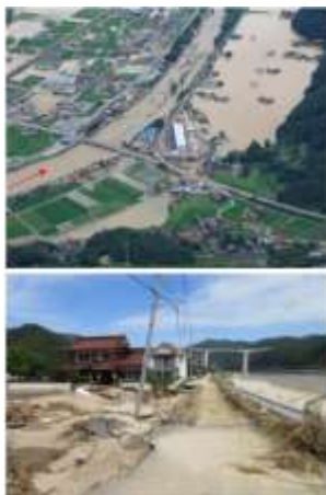
沼田川船木地区の氾濫（アジア航測）と越流による堤防侵食
