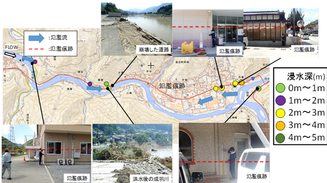
図 3-2-4-33 落合阿部地区における浸水状況
