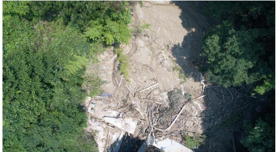
③ドローンで撮影。土石流が砂防堰堤で捕捉されている(7/16撮影)
