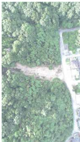
幅10m、長さ30m程度のがけ崩れが発生
