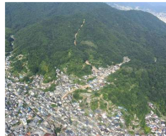
⑥尾根付近から発生した土石流が住宅地まで流下した(7/13撮影)
