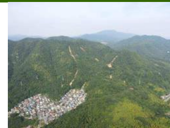
①尾根線付近から土石流が流下している（7/13撮影）
