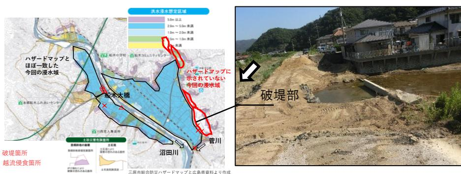
図3 菅川周辺のハザードマップと左岸の破堤による浸水被害の様子
