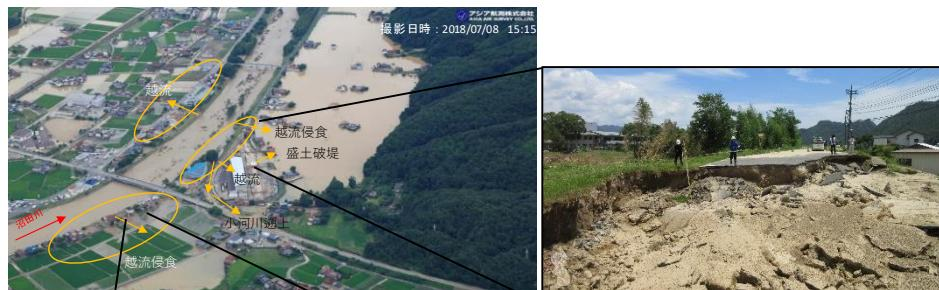
図4 越流による堤防侵食と氾濫被害（沼田川船木大橋周辺）
