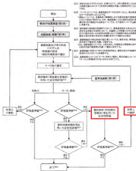
附属 3.1 基礎地盤及び周辺斜面の安定性評価の流れ
