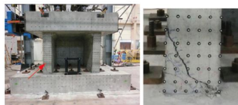
写真 3.3-1 厚さ方向の断面 5mm の状態の例 (壁厚 250mm)
