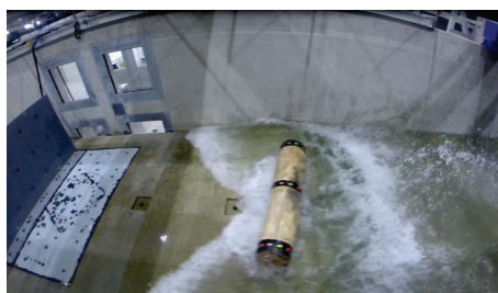
(1) 丸太漂流衝突試験（横置き）
