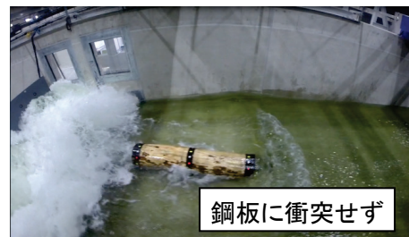
(2) 丸太漂流衝突試験（縦置き）
