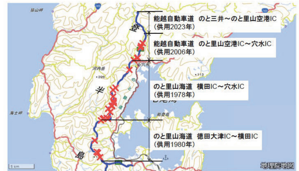
図 主要な道路盛土の被災位置 5)
