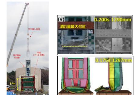
FRP製漁船の衝突実験(左図)と再現解析(右図)
