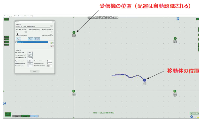
図-7 MarvelMind のシステムの位置測位画面
