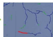
ひび割れの進展（赤線部）
