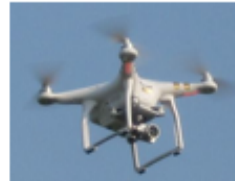
UAV(ドローン等)による3次元測量
