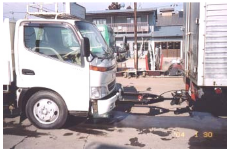
写真-1.1 機械式連結の例 (有)エーエス企画資料より引用
