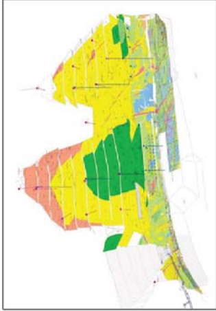
下流右岸法面の地質および断層のCAD化
