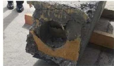
写真 2.8-2 ジョイントの破壊状況
