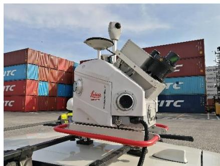
図 3-2 モバイルマッピングシステムの例
