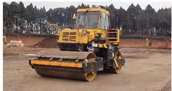
図2 レベル4複合自動化施工の実施状況<sup>\*)</sup>
