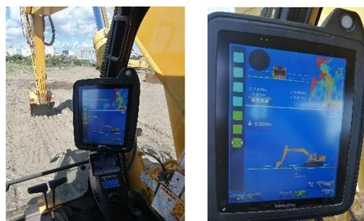
図-2 レベル2でのマシンコントロール (ICT バックホー)の実施状況
