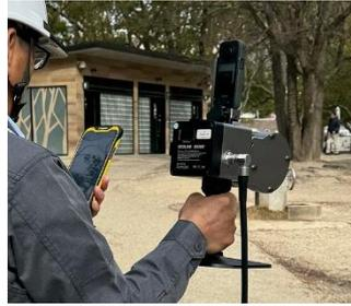
図 3-3 ハンディ型レーザースキャナーの例(出典: ニコントリムブル HP, [https://www.nikon-trimble.co.jp/products/product\\_detail.html?tid=448](https://www.nikon-trimble.co.jp/products/product_detail.html?tid=448), 2025/5/3)
