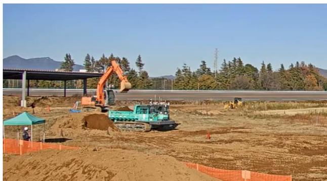
図 3-19 OPERA のロボット OS で自動運転をしている状態
