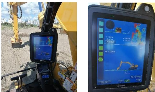
図 3-13 MG（マシンガイダンスの利用状況）
