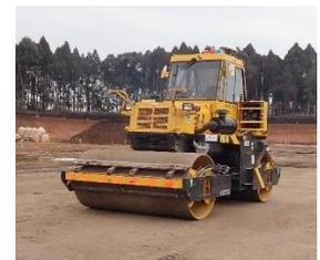
図-2 レベル4複合自動化施工の実施状況\*1
