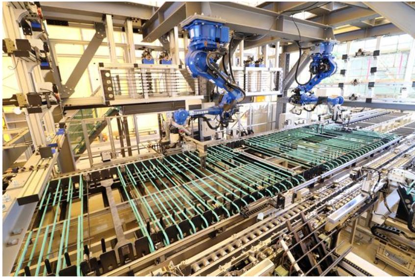
図 3-17 鉄筋の自動組立状況
