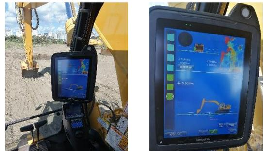
図-1 レベル2でのマシンコントロール (ICT バックホー)の実施状況
