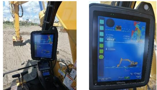
図1 レベル2マシンコントロールの実施状況
