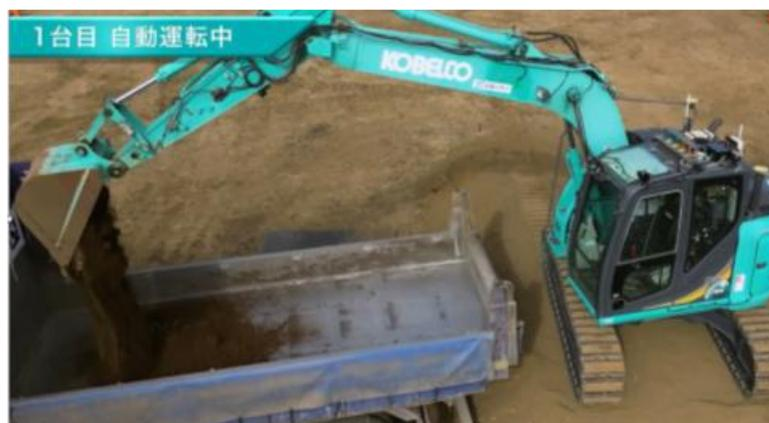
図 3-16 自動運転バックホーの作動状況
