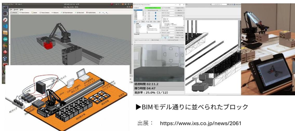
図 4.3-2 BIM/CIM モデルとロボットの双方向連動
