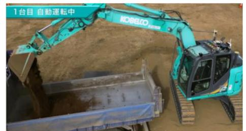
図1 自動運転建機動作状況\*1
