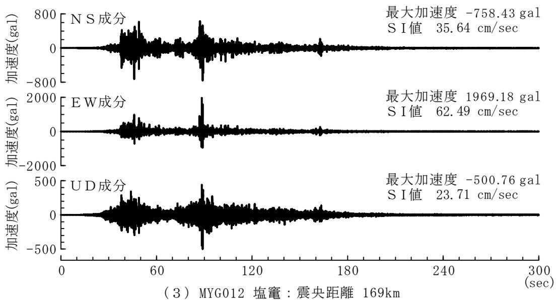
図 一 (1) 2011.03.11 14:47 東北地方太平洋沖地震(M9.0, 深さ24km)の加速度波形(防災科学技術研究所K-NET, KiK-netによる) I種地盤
