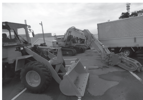
(c) がれき除去のための重機 敷地内が浸水した際に作業環境を確保するための重機で、高台に配備されている
