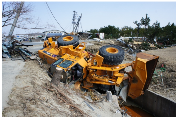
写真 67 津波で横倒しになった重機
