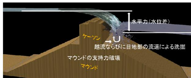
図 3.14 津波に対する防波堤の安定性に関する概念図
