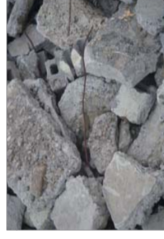
○分別されたコンクリートくず
