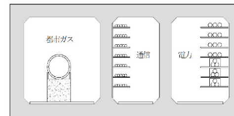
解説図 1.3.5 共用トンネルの例
