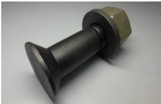
摩擦接合用皿型高力ボルト・六角ナット・平座金のセット(M22, C10T)
