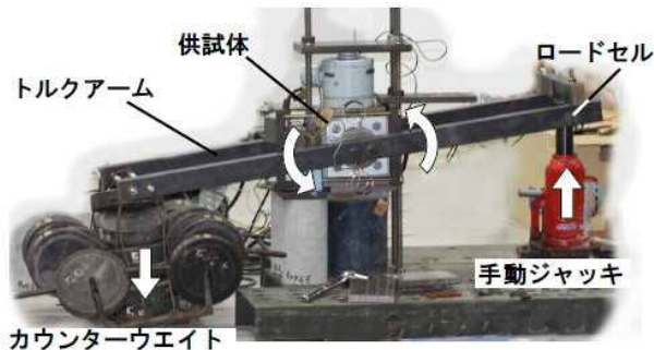
図 3.1.4.4 片押しトルク型せん断試験装置
