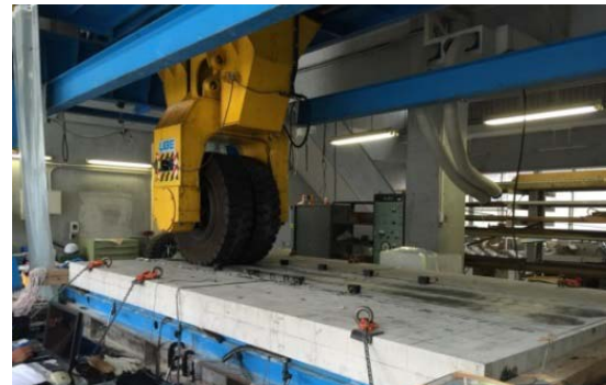
写真-1 輪荷重走行試験の状況
