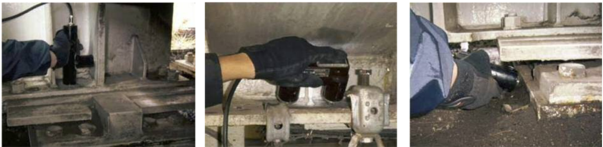
図-4 狭隘部用磁粉探傷装置
