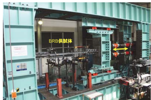
制震ダンパー(座屈拘束フリース, BRB)の性能実験(2009)
