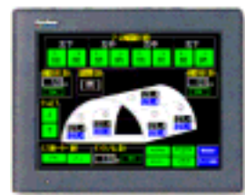
タッチパネル式操作盤
