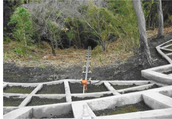
写真-1 地すべり自動観測システム動態観測機器として地すべりブロック頭部に設置された地盤伸縮計
