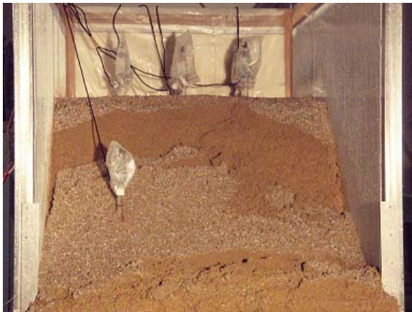
写真-3 斜面崩壊発生状況 (注水約 242 分後)
