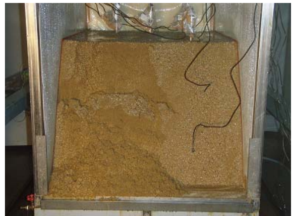
写真-4 斜面崩壊発生状況 (注水 21 分後)
