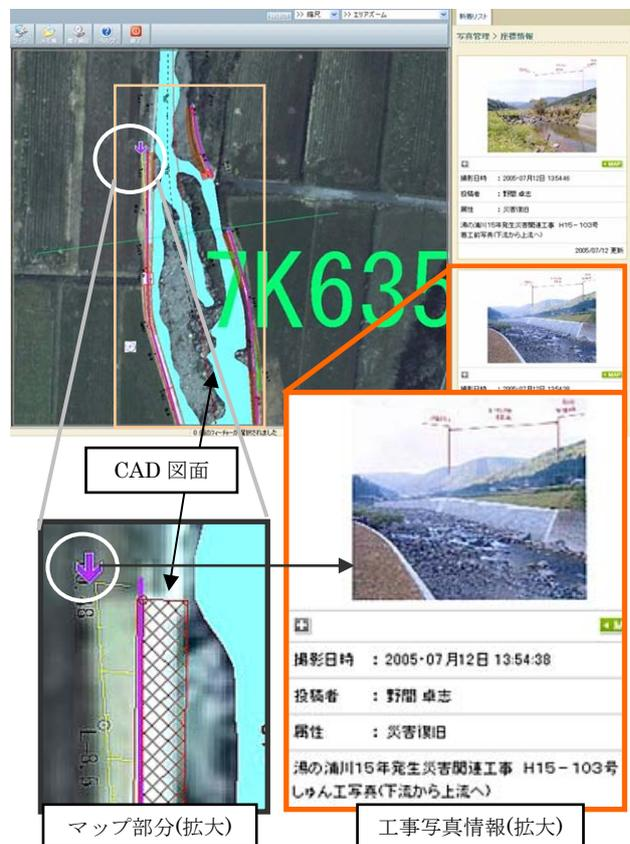
図-3 CAD 平面図との重ね合わせ
