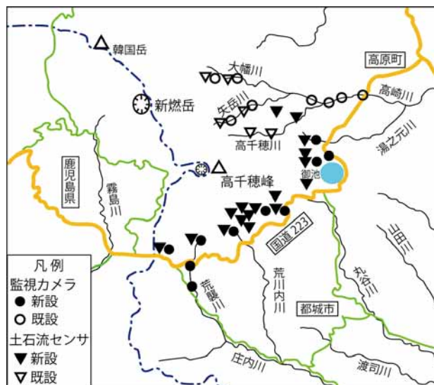
図 2.2.3.2 国土交通省が設置した溪流監視カメラと土石流ワイヤーセンサーの位置
