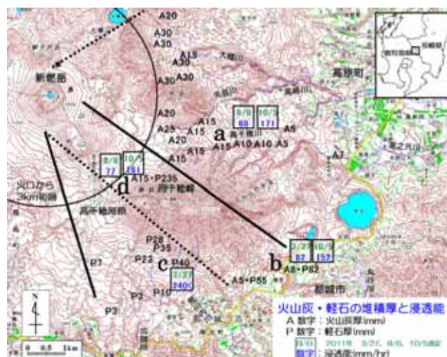
図 2.1.3.1 火山灰・軽石の堆積厚と浸透能測定結果※ ※文献 12) に 10/5 の浸透能試験結果を加筆
