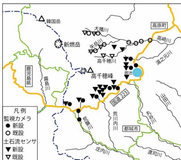
図7.1.2.1 溪流異常と土石流監視 国土交通省が設置した溪流監視カメラと土石流ワイヤーセンサーの位置
