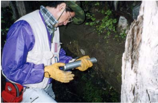
写真-5.35 ピン打ち込み試験器による計測
