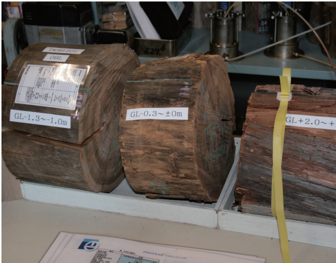
上：木杭の耐久性や腐朽を調べるための施設 中：無処理や腐朽対策を行ったカラマツやスギ 下：実際使用されていた古い木杭
