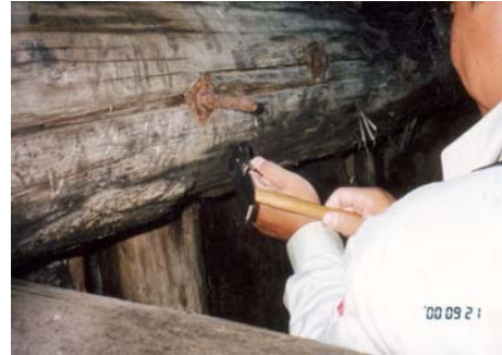
写真-5.34 応力波試験器による計測
