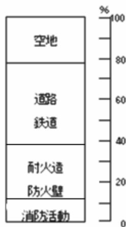
図4.3 阪神・淡路大震災における大規模火災の焼け止まり要因（出典：国土交通省都市防災対策室ホームページ http://www.mlit.go.jp/crd/city/sigaiti/tobou/hansin.htm ）
