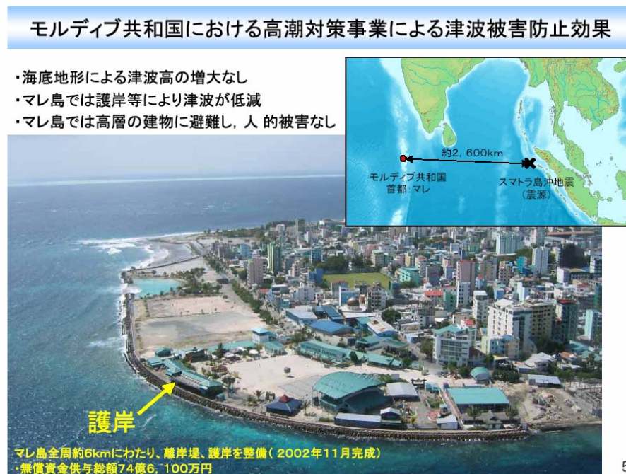
図4.4 モルディブ共和国における高潮対策事業による津波被害防止効果
