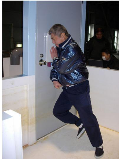
写真 - 3.3.3 ロードセルを用いた押し開け力測定
