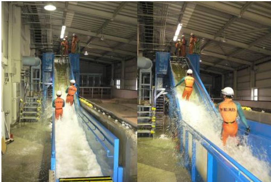
写真-5.1.5 階段の移動方法（ロープ使用）
