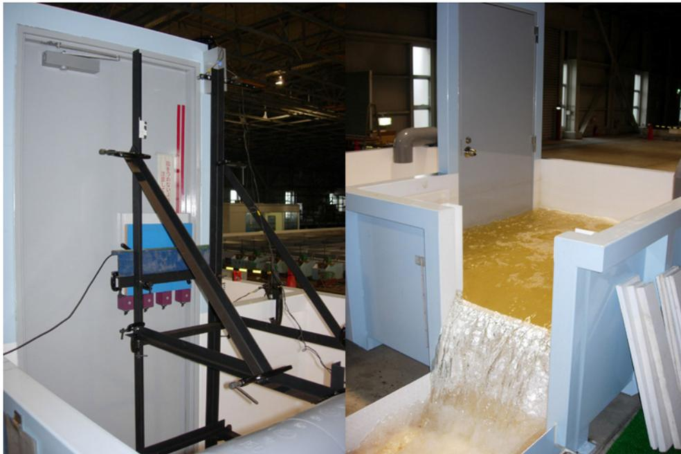
写真-3.3.4 ジャッキを用いたドアを開けるために必要な力の測定
