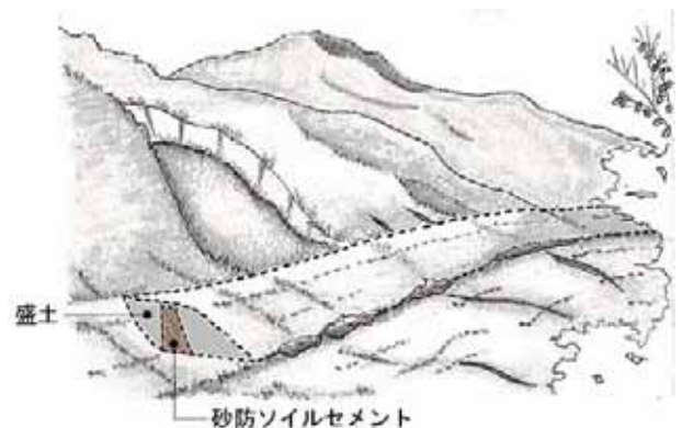
図7.1-9 砂防ソイルセメントによる斜面安定例 12)
