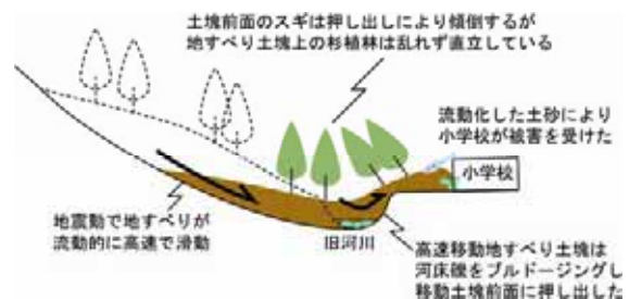
図 2.8-1 東竹沢での大規模地すべりの発生による芋川の閉塞と堰止め湖の発生
