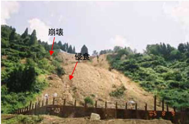
写真 3.1-16 梅雨前線豪雨による拡大崩壊（平成 17 年 6 月 28 日発生）小規模な崩壊崩土の侵食により土砂流出 （31 地点：上 04.11.26，下 05.8.9）
