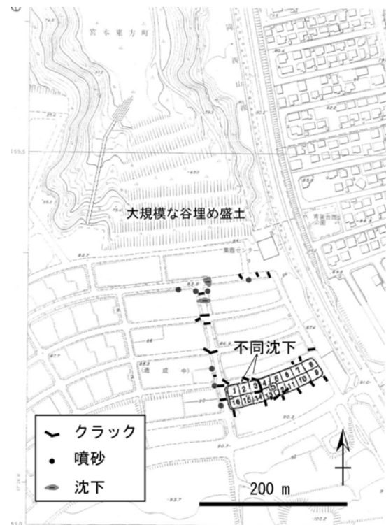
図 3.5-8 長岡ニュータウン（陽光台）における液状化被害
