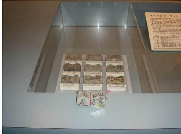
写真 2.4.2 小樽港防波堤に築造時に作製されたモルタルブリケット
