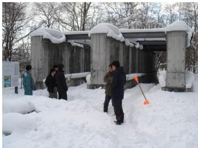
写真 2.4.1 初代十勝大橋から切り出したコンクリート桁の長期耐久性試験状況
