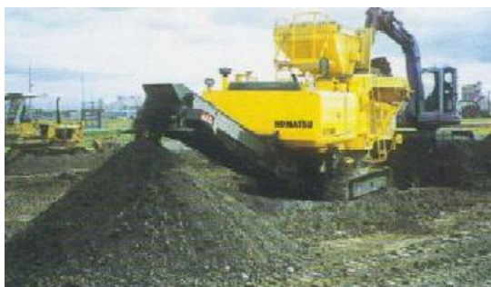
図 3.1.1.2-3 移動式プラント混合方式（例）
